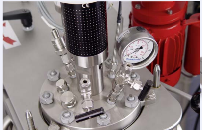
Cover plate with 7 openings Deckelplatte mit 7 Öffnungen
